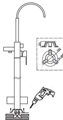
Serrer l'écrou et vissez les pieds au plan
