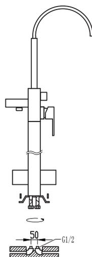
Connectez le tuyau d'arrivée du mitigeur à votre sortie d'eau
