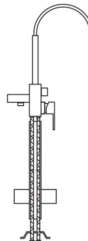
Passez le tuyau d'arrivée à travers la colonne, puis connectez-le au mitigeur
